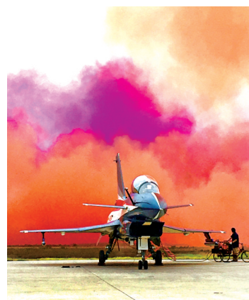
2016年7月15日，研究人员在地面进行拉烟剂效果试验。 刘飞保 摄
