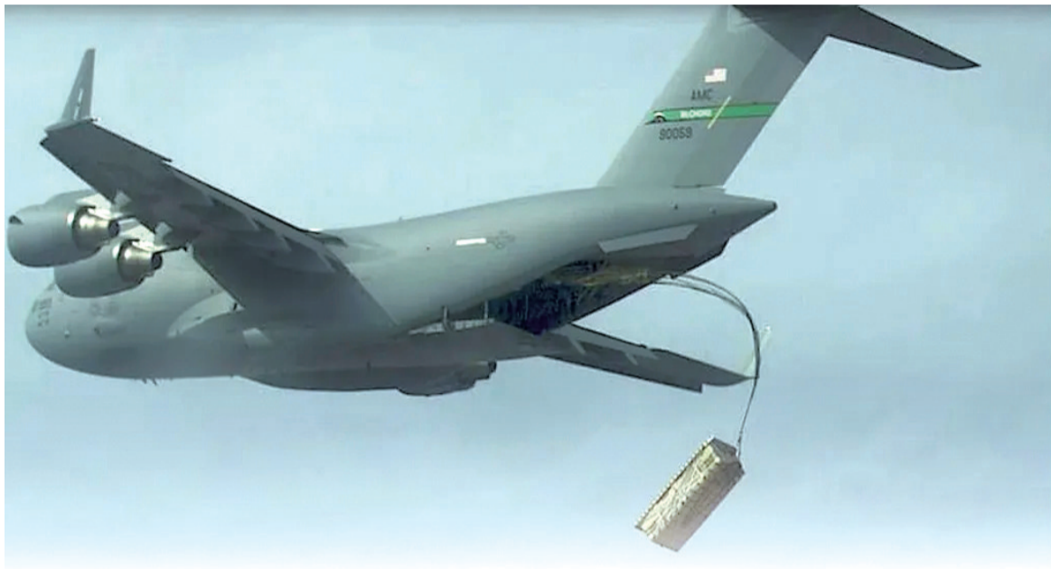
一架C-17A运输机正在使用模拟弹药测试“迅龙”系统。(图片来源:美国军事新闻网站“战区”)
