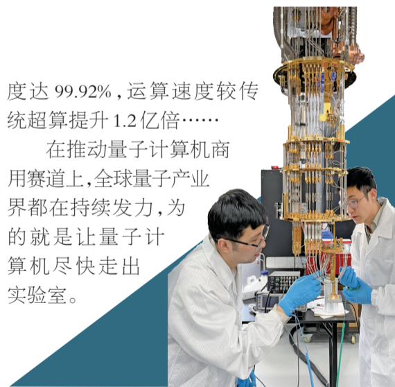
在量子科技长三角产业创新中心，科研人员对量子计算机进行安装调试。新华社发
