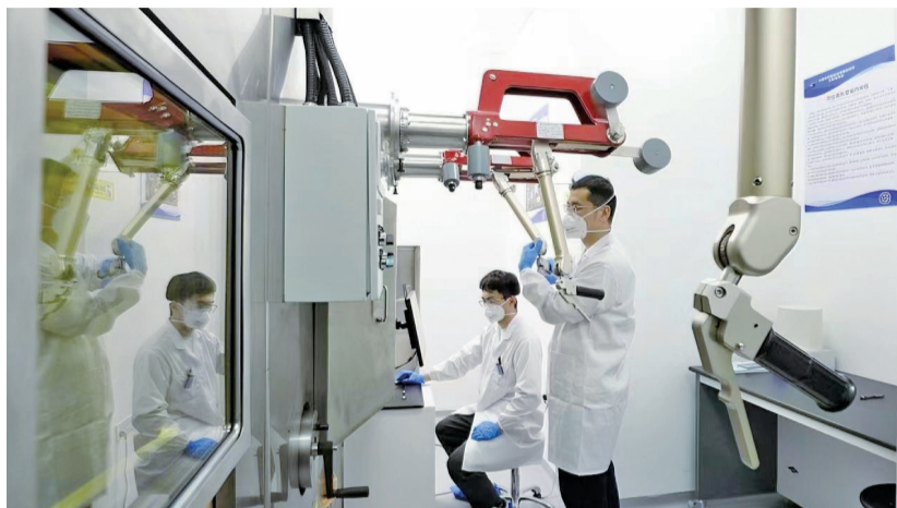
科研人员通过屏蔽热室机械手远程操作关键医用阿尔法同位素分离。 图片来源:中国科学院高能物理研究所官网
