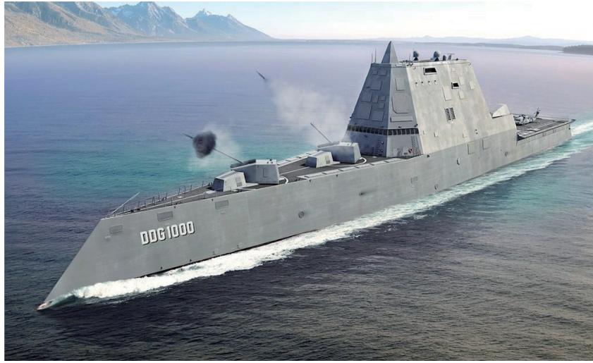
“朱姆沃尔特”级驱逐舰采用倒“V”字形舰体以降低雷达反射截面。(作者供图)
