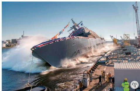
图①: 固定船坞式下水 图②: 浮船坞式下水 图③: 倒退式船台下水 图④: 侧滑式船台下水 图⑤: 吊运式船台下水 (作者供图)
