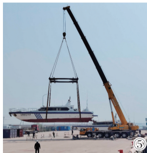
图①: 固定船坞式下水 图②: 浮船坞式下水 图③: 倒退式船台下水 图④: 侧滑式船台下水 图⑤: 吊运式船台下水 (作者供图)
