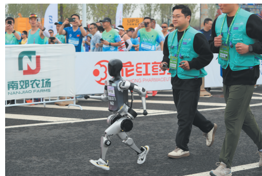
松延动力“N2”机器人脚穿的运动鞋,既增加地面摩擦力,又减轻关节震动压力。
