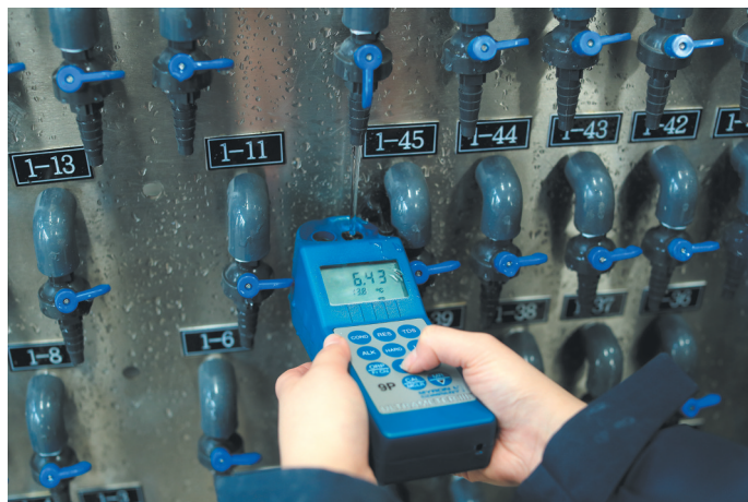
质检人员在进行海水淡化PH值的检测。
