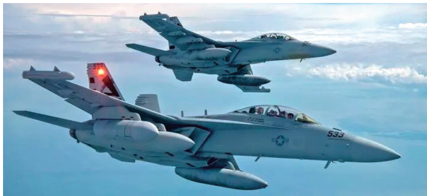
图为两架“咆哮者”电子战飞机编队飞行，飞机携带下一代中频干扰吊舱 AN/ALQ-249。
