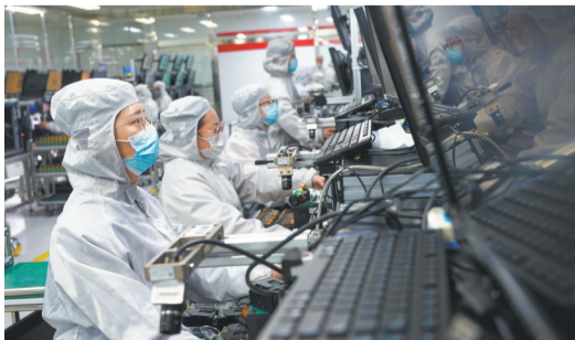
2024年4月26日,杭州市富阳区安防设备企业,工作人员在球机机芯测试线上做清晰度测试。
