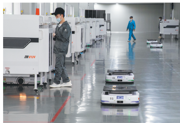
2025年2月7日,嘉兴平湖市一太阳能电池企业,AGV 移动机器人穿梭在生产线上输送物料。 王强 摄
