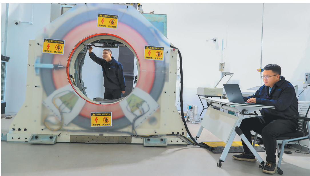
▲2024年12月9日,北京亦庄中核粒子医疗科技有限公司内,研究人员在进行医用直线加速器诊疗设备性能测试。
