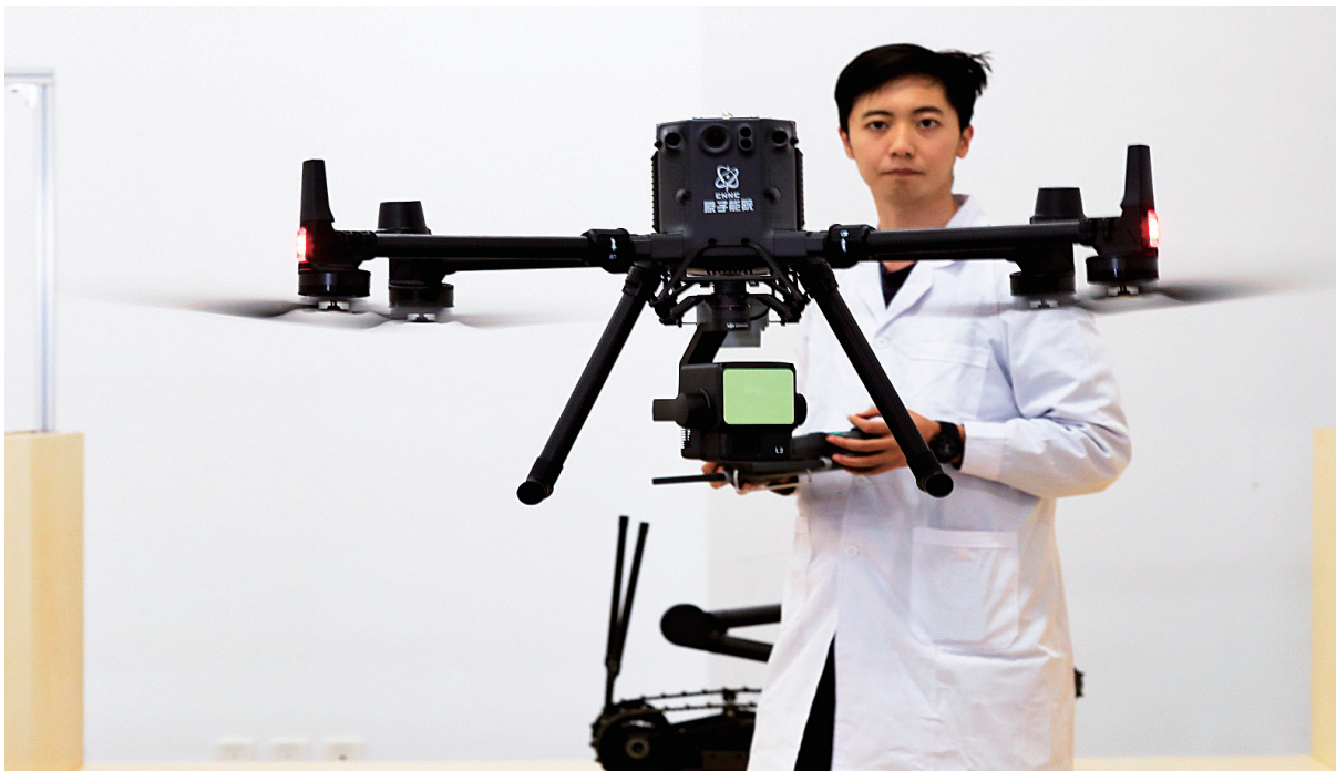
科研人员调试搭载核辐射探测系统的无人机。
