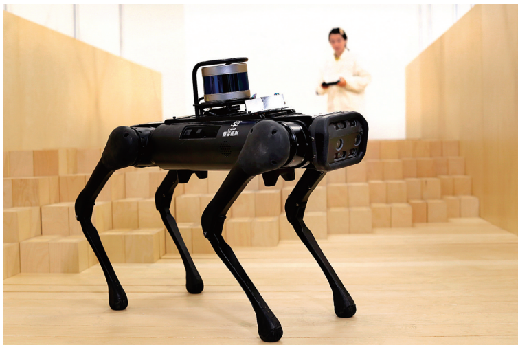
科研人员在模拟场景下测试核辐射探查机器狗跨越障碍的能力。
