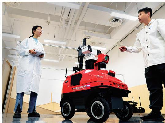
研发团队在实验室模拟测试核辐射监测机器人。
