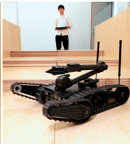
名为“笨笨”的耐辐射履带式机器人,在模拟场景下测试攀爬能力。
