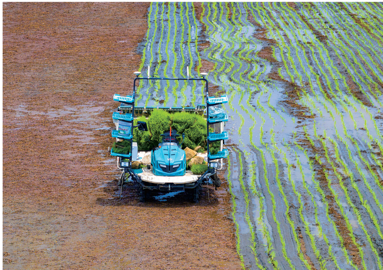
江苏省兴化市临城街道赵何村一片繁忙景象，无人驾驶插秧机通过北斗导航系统在田间进行精准作业。 视觉中国供图
