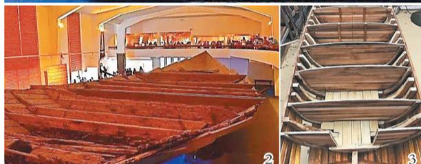
图1为水密隔舱壁船舶复原，图2为宋代海船水密隔舱壁出土文物，图3为新制水密隔舱壁实物。（作者供图）
