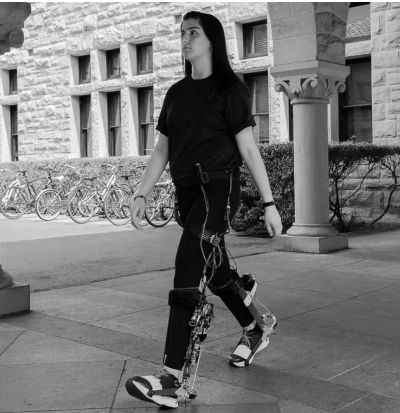
试用者在便携式踝关节外骨骼的帮助下行走。
