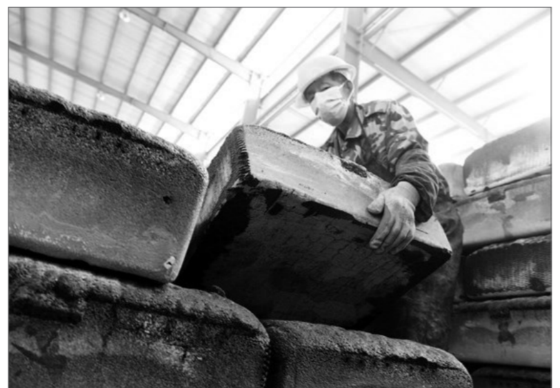
中海油能源发展股份有限公司清洁能源公司泡沫玻璃生产线自动化程度高,200多米长的窑炉生产线,仅需两名工人就能完成操作。泡沫玻璃是目前液化天然气储罐和管道建设中不可或缺的材料。图为车间工人搬起泡沫玻璃半成品,准备对其进行分类码放。 李佑坤 王曼 摄
