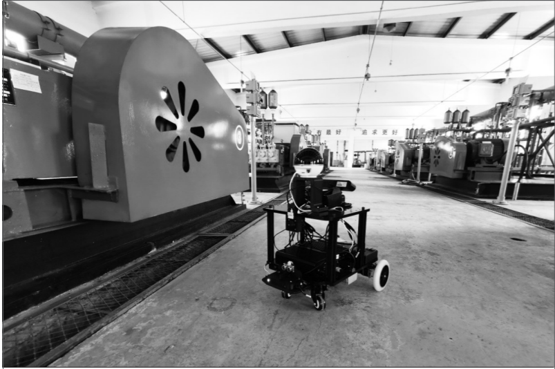
图为工作中的自动巡检机器人。
