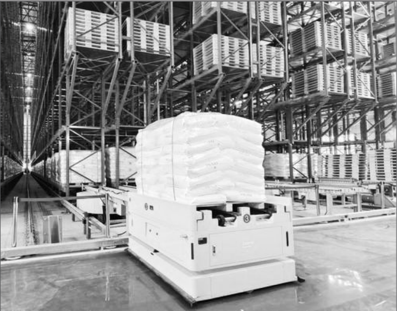
巴陵石化橡胶部年产5万吨热塑橡胶SEBS新装置智能化立体仓库,目前运行平稳。装置两条后处理生产线的SEBS成品码垛下线后,由AGV(自动导引运输车)转运至立体仓库入库输送机,再由堆垛机将码垛成品运送至立体货架进行存储,发货时堆垛机将立体货架上码垛成品提取送至出库输送机,再由RGV(有轨穿梭小车)送出仓库进行装车。
