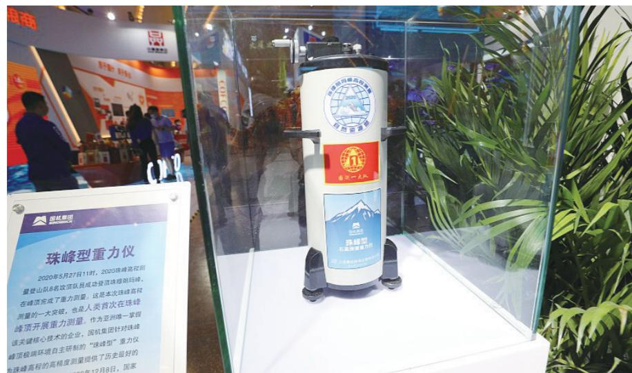
2021年中国品牌日活动在上海展览中心揭开帷幕。图为展出的国机集团研制的珠峰型重力仪。2020年5月27日11时,2020珠峰高程测量登山队8名攻顶队员成功登顶珠穆朗玛峰,在峰顶完成了重力测试。这是本次珠峰高程测量的一大突破,也是人类首次在珠峰峰顶开展重力测试。作为亚洲唯一掌握该关键核心技术的企业,国机集团针对珠峰峰顶极端环境自主研制的“珠峰型”重力仪为珠峰高程的高精度测量提供了历史最好的海拔高程起算基准。
