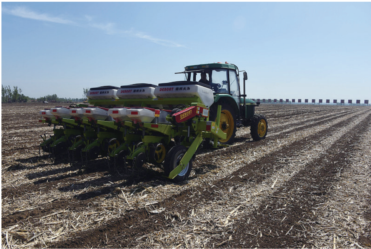
“梨树模式”是由中科院东北地理与农业生态研究所、沈阳应用生态研究所和中国农业大学合作研究开发的保护性耕作模式,最早在吉林省梨树县建立研究基地并推广示范而得名,为因地制宜开展东北黑土地保护与利用提供系统解决方案。图为“梨树模式”研发的免耕播种机在吉林的万亩示范区现场作业。
