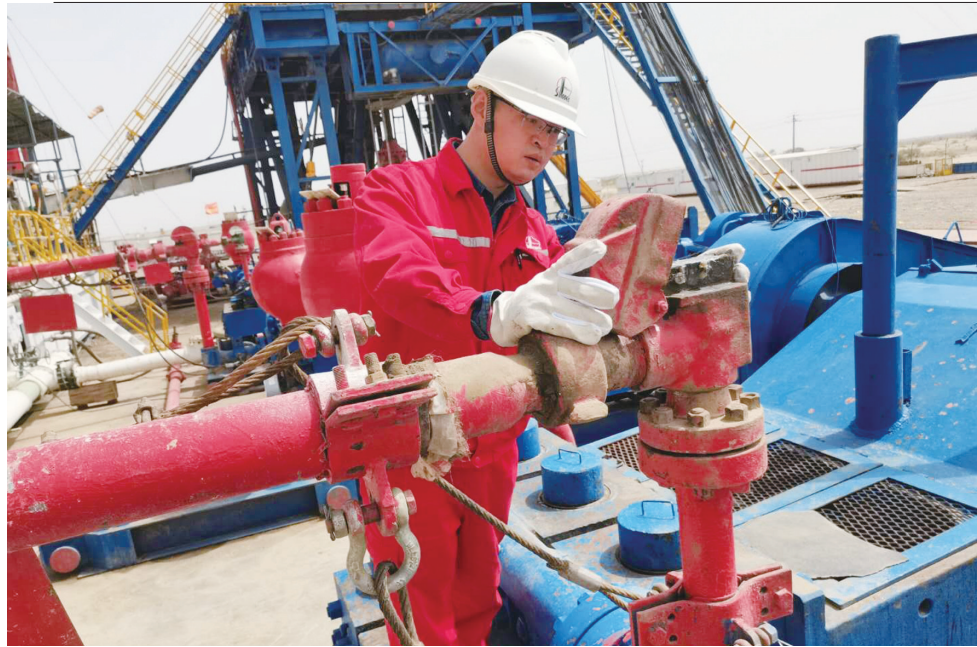
图为李庆光检查关键要害部位泥浆泵安全阀压力设定等级。
