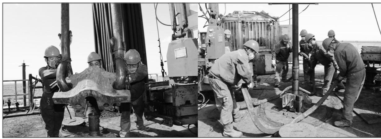
6月7日,塔河油田TH12383H井酸压完井管柱顺利下至设计井深,并安装井口试压合格。这口使用850型修井机施工的定向短半径侧钻井圆满收工,相比常规侧钻井施工节资500余万元。
