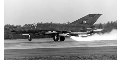
1985年3月16日,原民主德国(也是我们父辈口中常说的“东德”)人民空军JG7联队一架空军苏制米格-21PF战斗机正在演练RATO起飞。机翼下方携带有导弹挂架,但是并未挂载空空导弹。所谓RATO,就是英文Rocket Assisted Take Off(火箭助推起飞)的缩写,换成中文,就是“火箭助推起飞”。如果细看,就会发现这架战斗机的腹部后方安装了两台白色圆柱体,而且正向后喷出明亮的火焰。这两个白色圆柱体,便是两台火箭助推发动机。所谓火箭助推起飞,就是利用安装在飞机机体上的火箭助推器与飞机自身发动机一起合力,在短时间内提供惊人的推力,极大地提高飞机的滑跑速度,使其在很短的跑道上实现起飞。飞机起飞后,两台耗尽燃料的火箭助推器会被抛
