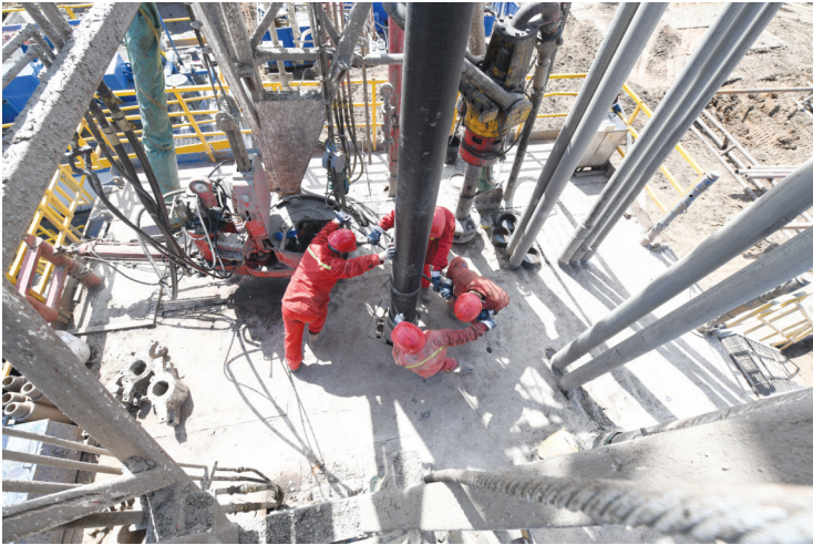
图为钻工正在进行下表层套管作业
