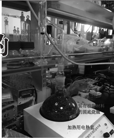
行遇冷凝结，在收集器中滴落并得到收集。
