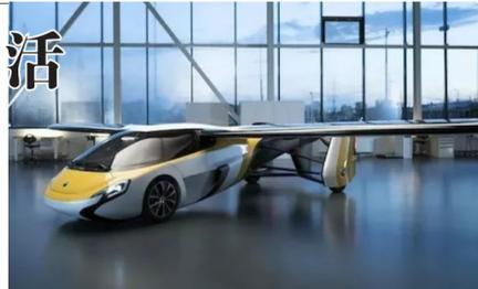
图为在首届中国国际进口博览会明星展品之一的“会飞的汽车” AeroMobil。这辆无人驾驶的汽车线条流畅，颇具科幻感，两个车门开启后不断延展转变成机翼，收紧的后车厢以及车尾提供动力的螺旋桨，使其最终变成飞机造型。
