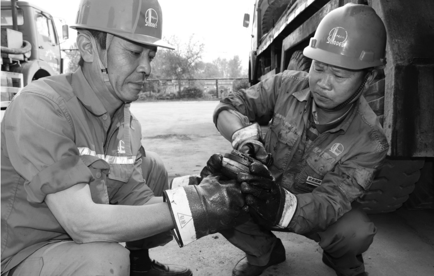
10月19日上午,河南油田油服中心特车大队101队水泥车司机郭守岩(左)、董文正在更换柱塞泵凡尔。
