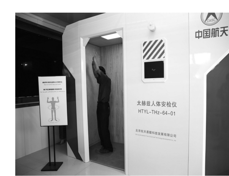
图木舒克公安局两峰山公安检查应用的被动式太赫兹人体安检仪在工作中。
