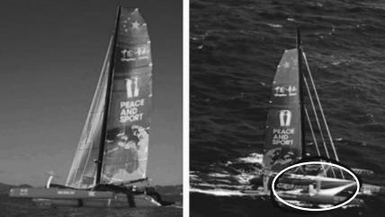
右图中标注处可见落入海中的大三角帆撞”。在海上航行的船只在高速行驶之下撞到暗礁、鲸鱼，甚至是其他出事船只的碎片，都是极有可能发生的“正常现象”，而对于郭川的三体帆船来讲，这样的碰撞发生一次就极有可能酿成无法挽回的大祸——因为三体帆船为了提高速度减轻重量，通体为玻璃钢制成，强度着实有限。一旦发生就很容易破损，在几分钟之内就有可能沉船。不过船只破碎已经被排除了可能。但这却不排除轻微碰撞或是紧急规避之下强大的惯性作用于郭川的情况。
