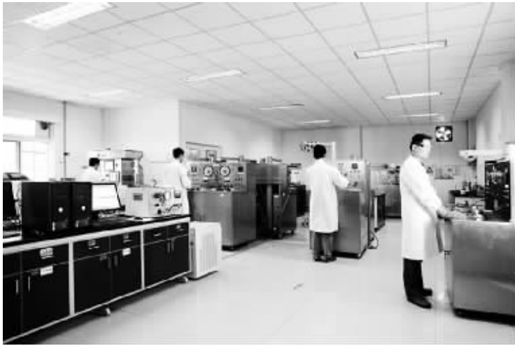
图为油田化学事业部员工在固井实验室做固井增压养护釜和水泥浆稠化仪的操作实验,通过模拟水泥浆从井口到底注入随温度、压力的变化过程,测量和记录水泥浆的稠化时间、失水、凝固状态等性能。
