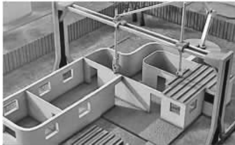
“轮廓工艺”打印房屋
