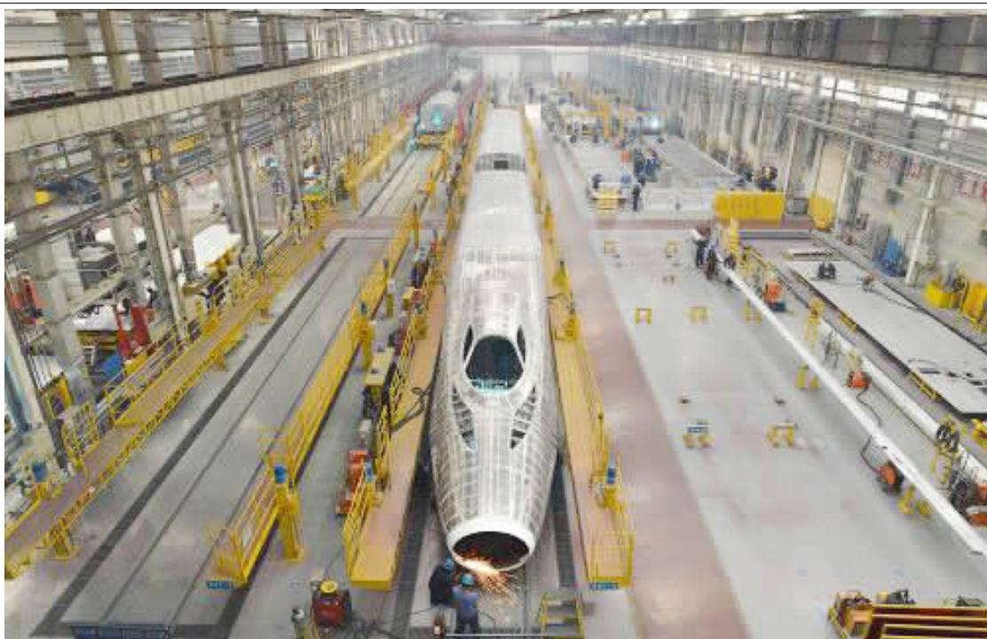
1 月 3 日,CR-B80A 高速动车组在中国南车四方股份公司车体制造车间组装。CR-B80A 高速动车组由中国南车四方股份公司自主研发,最高运行速度达到 380 公里/小时,成功实现头型、轻量化车体、转向架、减振降噪、系统集成等关键技术的突破。截止到 2013 年 12 月底,中国南车四方股份公司已成功交付 146 列 CR-B80A 高速动车组,在京广、京沪、沪杭等 10 条高速铁路上投入运营,累计安全运营里程已达 1.6 亿公里。
