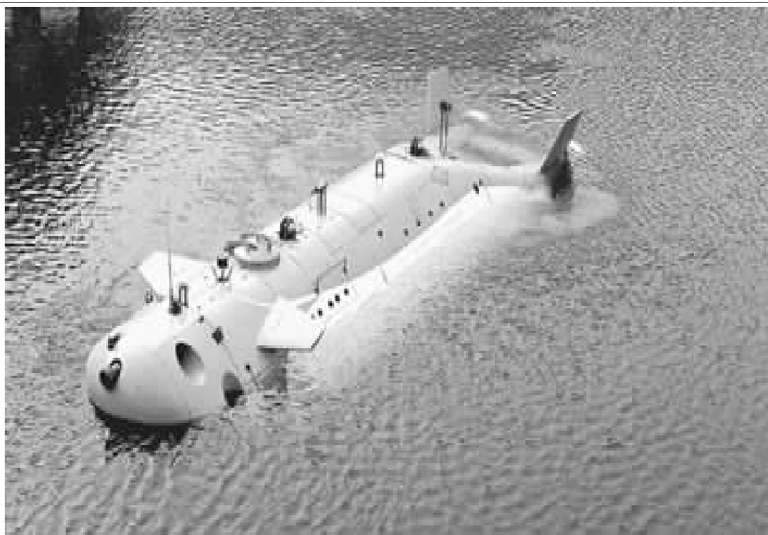
11月21日,我国首个实验型深海移动工作站(也称“深海空间站水池试验平台”),在完成总装集成和陆上联调基础上,成功进行了第一期首次水池试验。该设施不受海面环境制约,可长周期、全天候在深海海域直接作业,代表了海洋领域的前沿核心技术水平。
