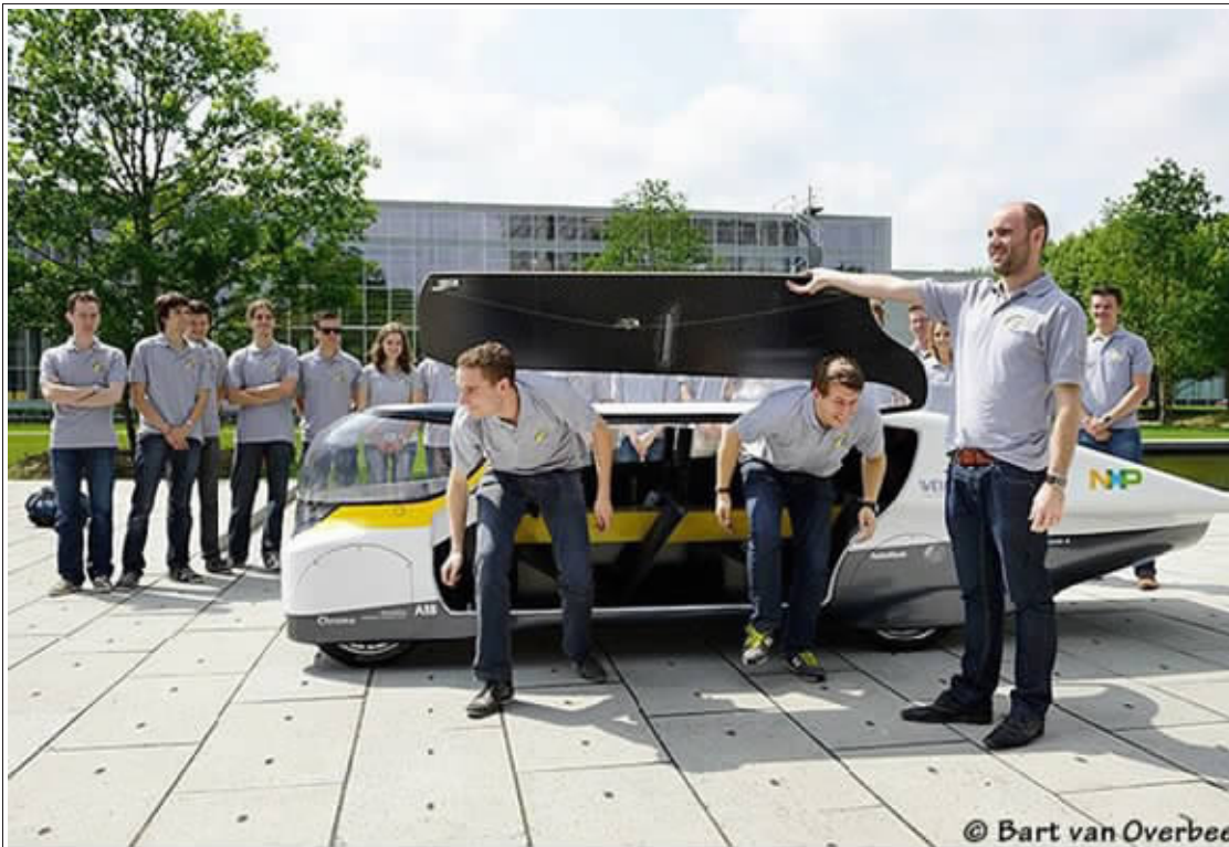
11 月 3 日,名为“Stella”的全球首辆太阳能家用车亮相,“Stella”结合电动车和太阳能车的特点,太阳能板安装在车顶,同时以电池驱动。一天充电一次,便可在白天驾驶 800 公里,行驶路程比一般电动车多三倍,最高时速达 120 公里。
