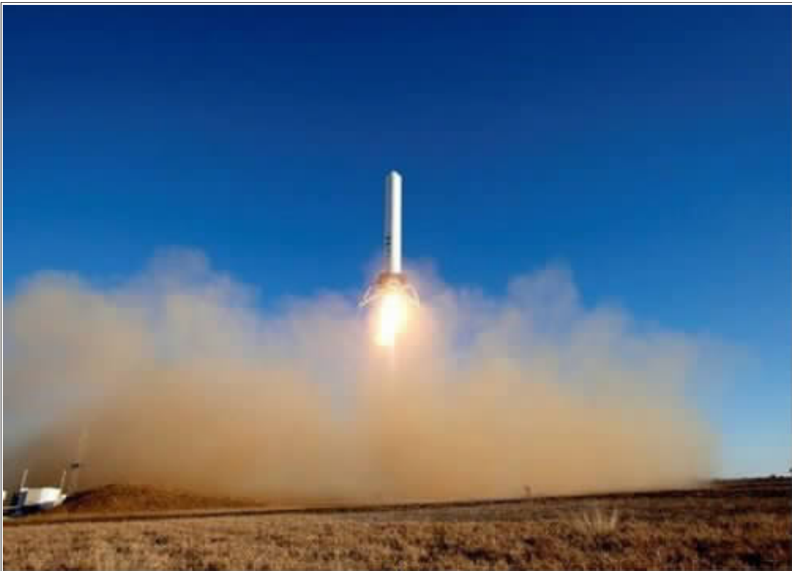
据美国 SpaceX 公司发布消息称,在 10 月 7 日的测试中,SpaceX 公司研发的“蚱蜢”火箭完成了“第八跳”,在发射测试中成功升空 744 米,随后准确降落到发射台上。
