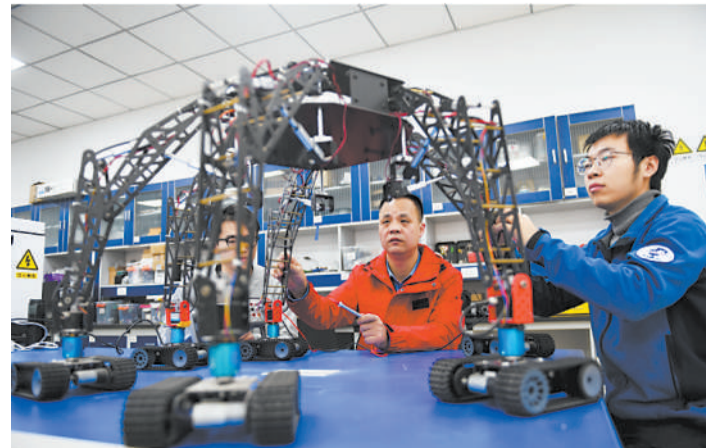
图为太原理工大学师生正在研究南极冰盖多足机器人。受访单位供图
