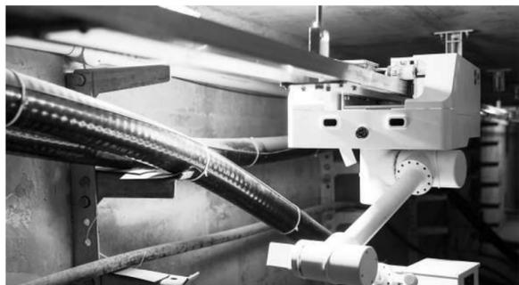
图为电缆隧道智能巡检机器人。沈仪摄
