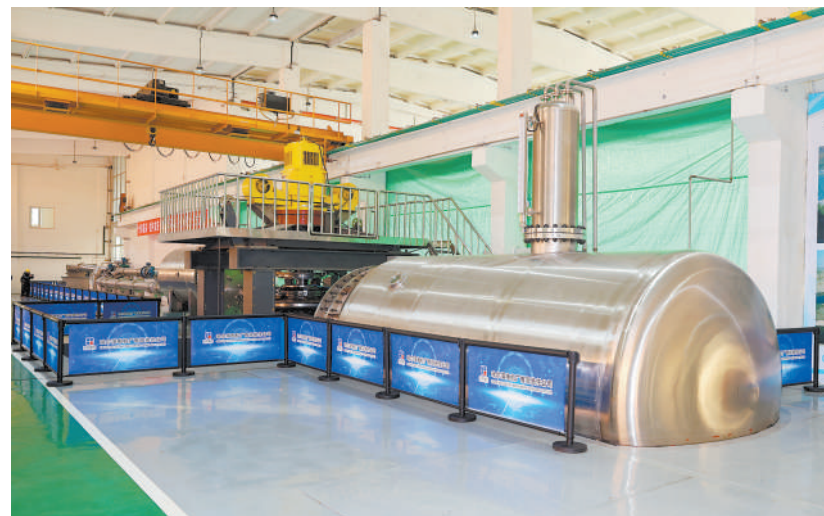
350米高水头冲击试验台。受访单位供图
