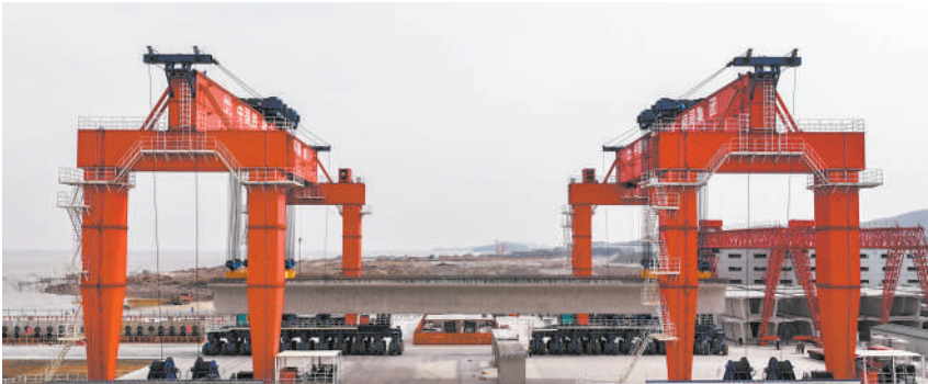
“沧龙号”搬梁机。中国铁建大桥局供图
