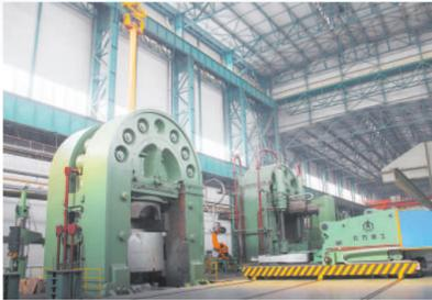
大型难变形金属件重型挤压制造关键技术在北重3.6万吨黑色金属垂直挤压机上应用。
