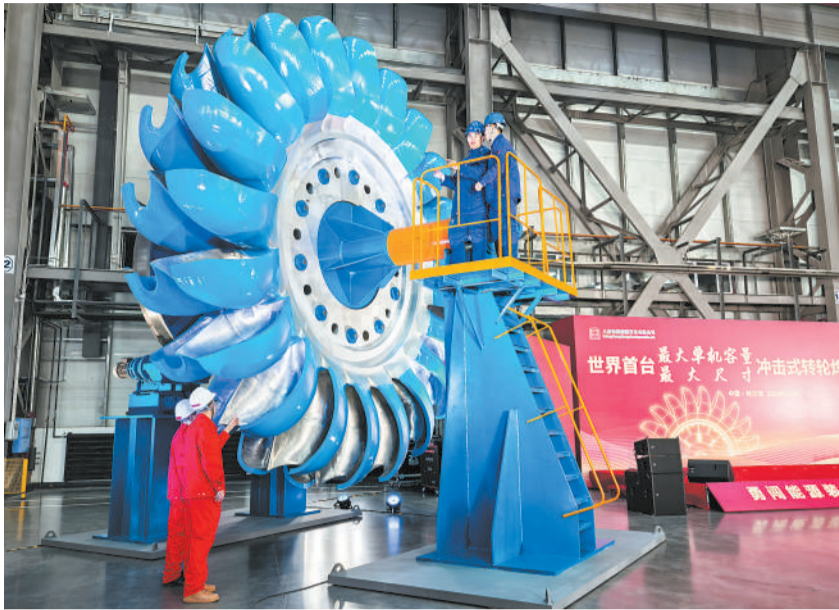
2024年12月30日，世界首台最大单机容量、最大尺寸扎拉500兆瓦冲击式水轮机转轮在哈电电机焊接制造成功。 本报记者 李丽云摄
