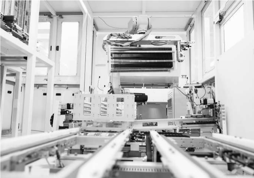
在四川省丹棱县经开区的眉山臻升光伏8吉瓦高效异质结电池项目电池车间清洗制绒工序中，机械臂搬运硅片。新华社记者 江宏景摄
