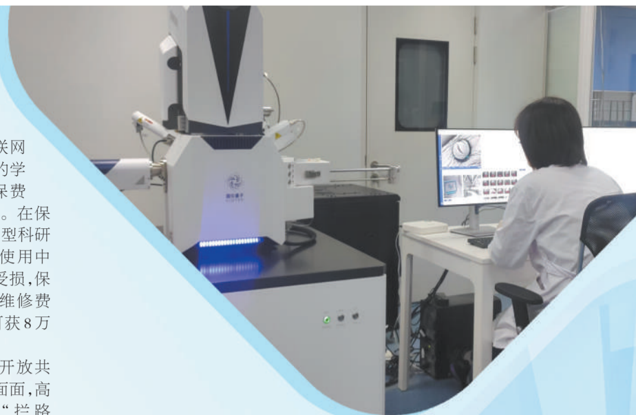
▲图为中国农业科学院作物科学研究所技术人员在操作场发射扫描电子显微镜。
