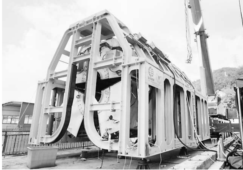
依附于海底管道的空气潜水可进人多元检修干式作业舱。
