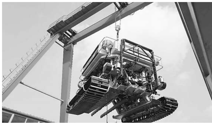
图为我国首台作业时速公里级水下敷缆机器人。受访单位供图
