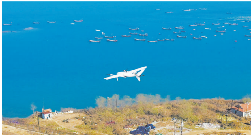
搭载高比能宽温域锂离子电池的新型工业级复合翼无人机正在试飞。张盟摄
