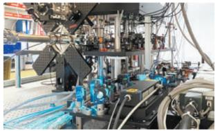
图为铷原子冷却装置的一部分。激光器发出的光用于捕获铷原子。
