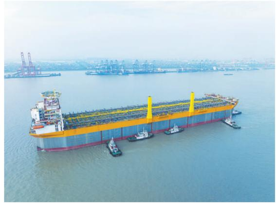
图为230万桶通用型海上浮式生产储油轮“捷豹”号。受访单位供图
