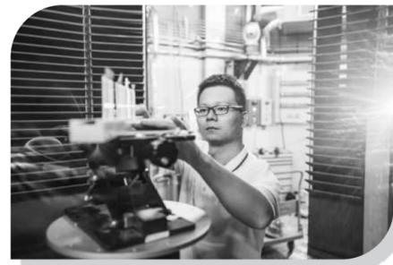
中国散裂中子源科研人员演示用能量分辨中子成像谱仪进行电池检测。
