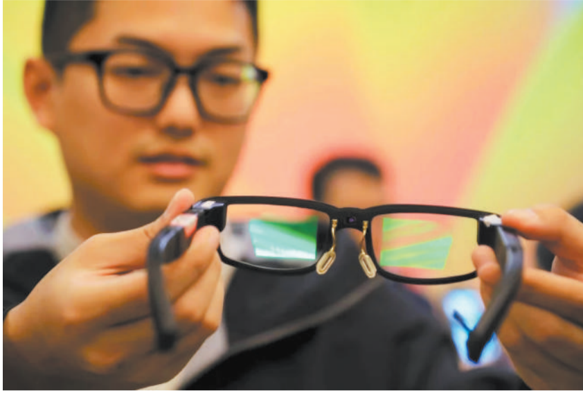
张宇宁团队和立讯精密合作研制的偏振体全息光波导AR眼镜。张宇宁供图
