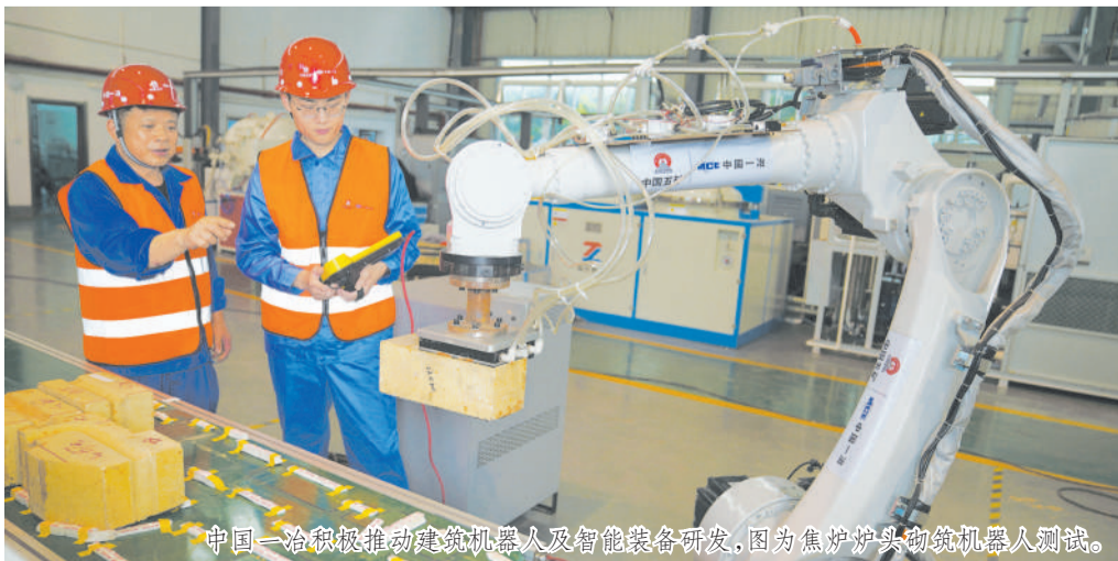
中国一冶积极推动建筑机器人及智能装备研发,图为焦炉炉头砌筑机器人调试。
